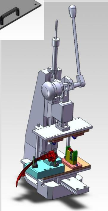
**HELLA – Slowakei –Vorrichtung für Kontaktpressen in die Platine und Nieten von Platine in DAIMLER-Buchse**
