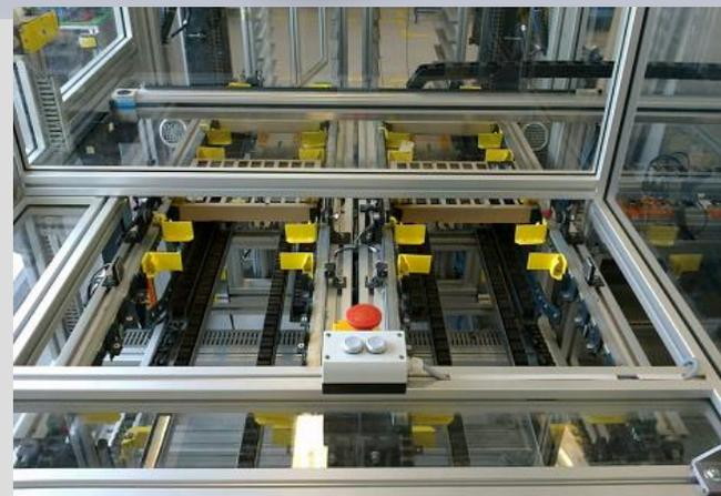
**FAURECIA Lozorno** – JIT chariots pour siège avant et arrière, manipulateur des sièges et tables tournantes
