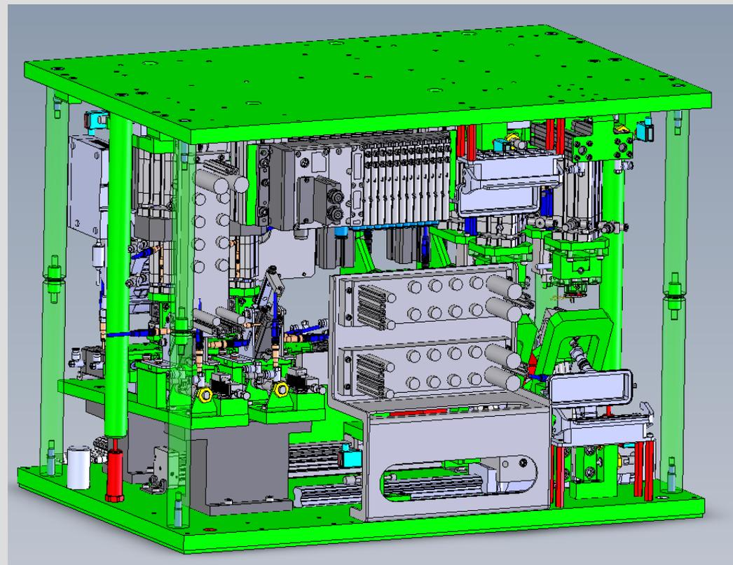
**HELLA – Slovaquie** - Système de vision pour tester des fissures sur des feux plaque d'immatriculation (VW , AUDI) avec système de stockage automatique
